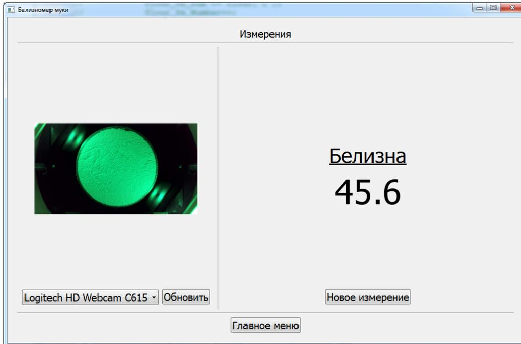
Рисунок 9.7. Результат измерения
